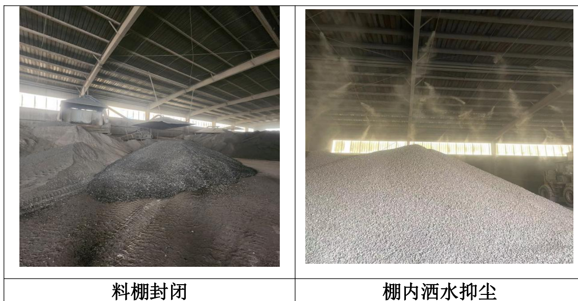
图 6 物料储存封闭情况
